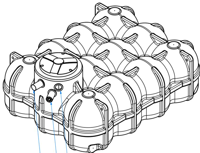
Anschluss für Technikrohr DN110 (Leerrohr)
