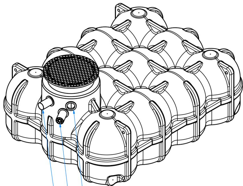
Anschluss für Technikrohr DN110 (Leerrohr)
