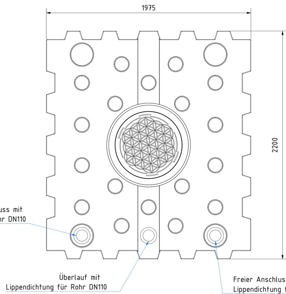
Freier Anschluss mit Lippendichtung für Rohr DN110
