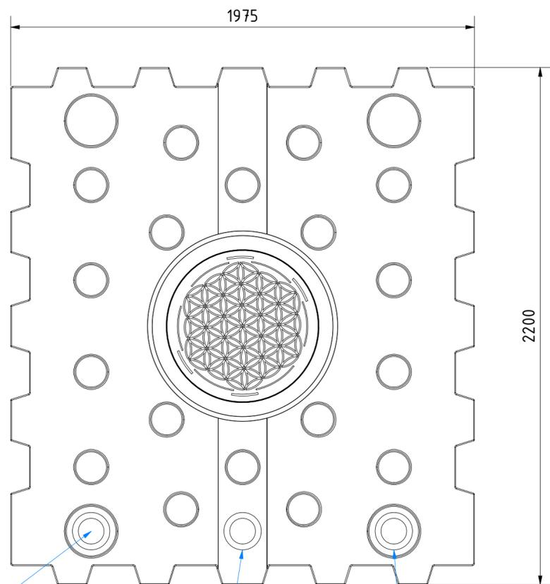
Freier Anschluss mit Lippendichtung für Rohr DN110
