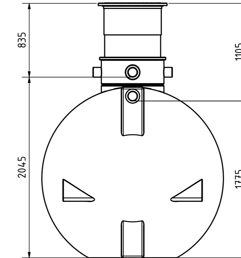
Schnitt durch den Dombereich zeigt bauseitige Montage des Hausfiltersets
