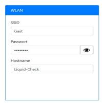
In diesem Menü tragen Sie die Zugangsdaten zum Verbinden des Liquid-Check mit Ihrem Heimnetzwerk ein. Sofern dies nicht bereits schon durch die WPS-Verbindung eingetragen wurde.
