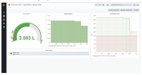
Sobald die Cloud-Funktion aktiviert ist, sendet "Liquid-Check" seine letzte Messung jede Stunde zyklisch an das Portal. Zusätzlich werden die Daten bei einer manuell aktivierten Messung sofort an das Portal gesendet.
