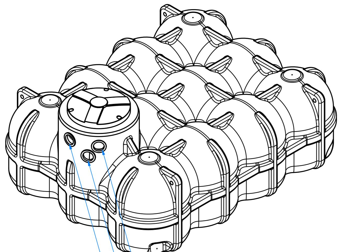
Anschluss für Technikrohr DN110 (Leerrohr)
