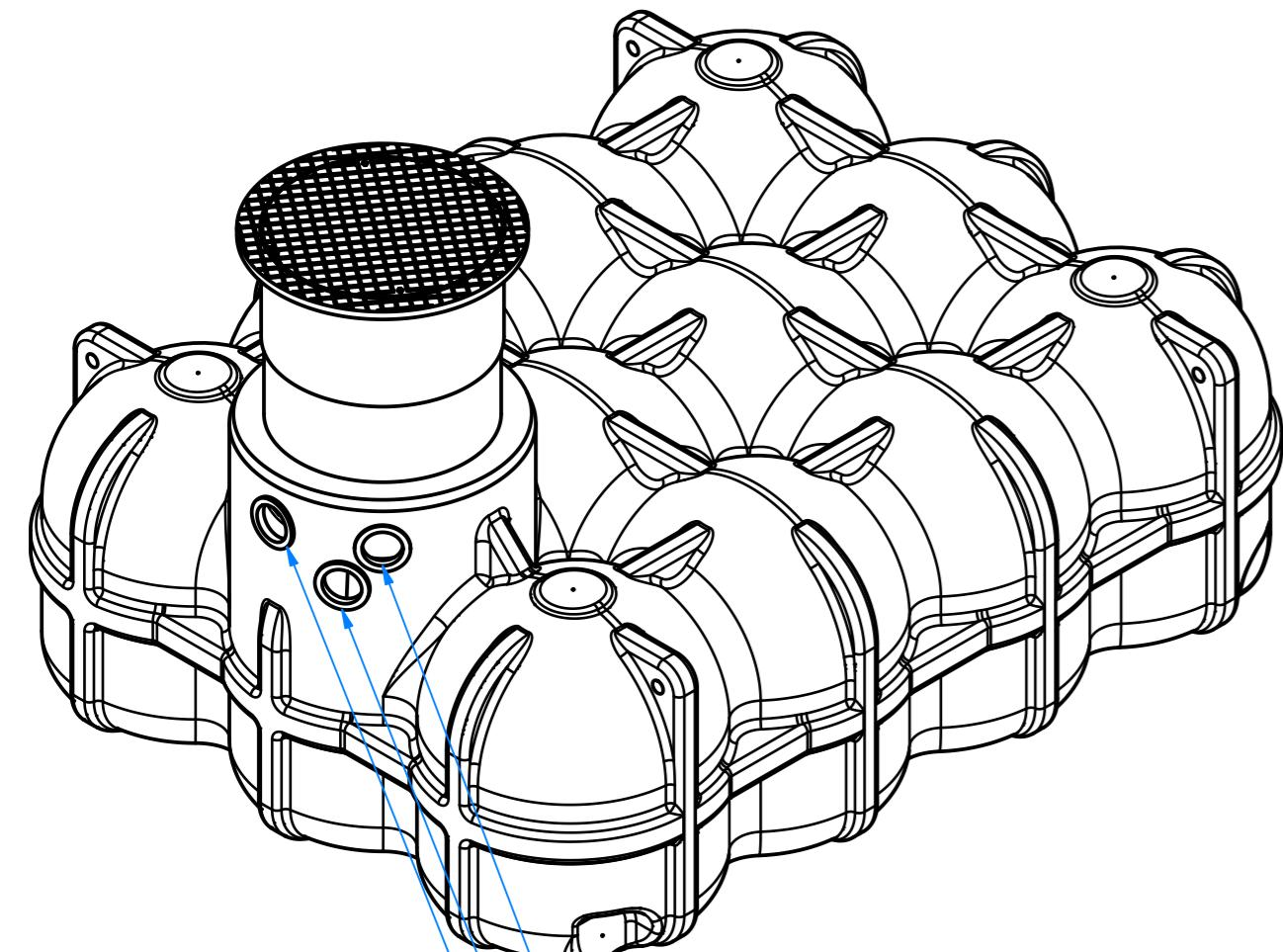
Anschluss für Technikrohr DN110 (Leerrohr)
