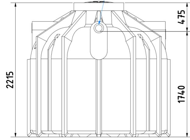
Anschluss für Technikrohr (Leerrohr) DN110
