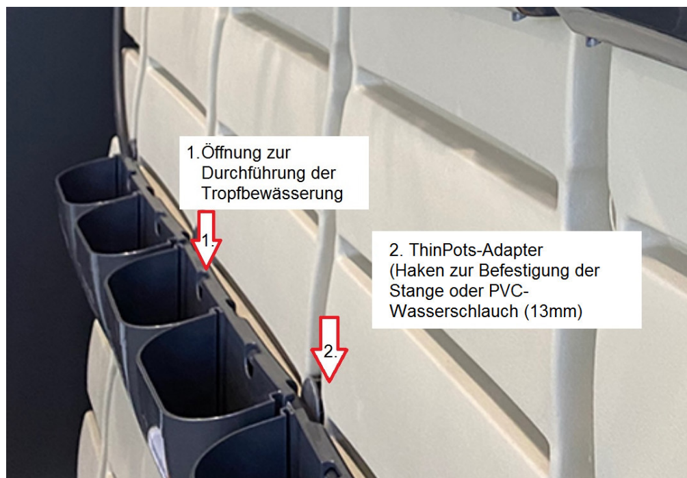
Bild: Montage ThinPots und Anschlussmöglichkeiten einer Tropfbewässerung
